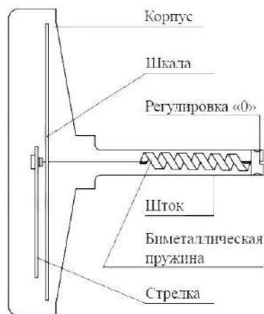
Рис.1 – Конструкция прибора.
